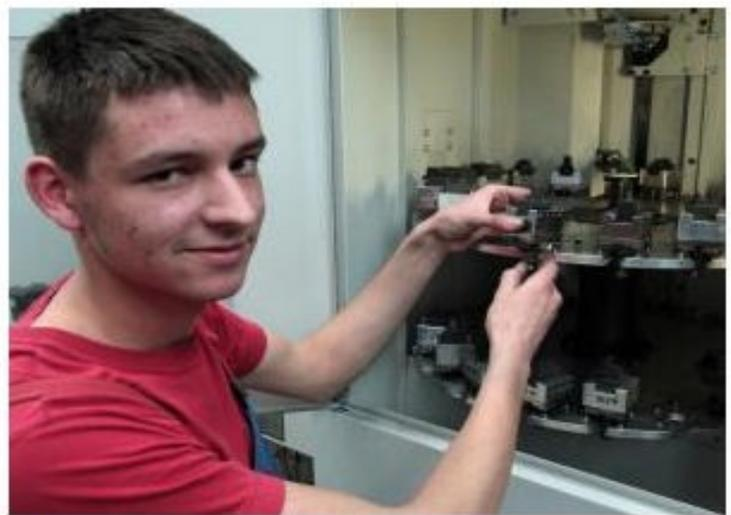
Philipp Riedel aus Gehringswalde ist CNC-Fräser. Hier bestückt er einen Werkstückwechsler an einer CNC-Fräsmaschine.
